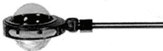
Figura 38 - Radiometro netto: si osservino le cupolette che proteggono le superfici sensibili che ricevono la radiazione dall'alto e dal basso.
