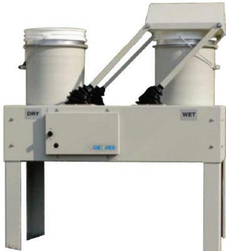
Figura 34 – Collettore *wet - dry*. In assenza di pioggia il contenitore *dry* è aperto e quello *wet* è tappato. Con l'inizio della pioggia un pluviostato fa sì che il sistema di chiusura del collettore passi da quello *wet* a quello *dry*.
