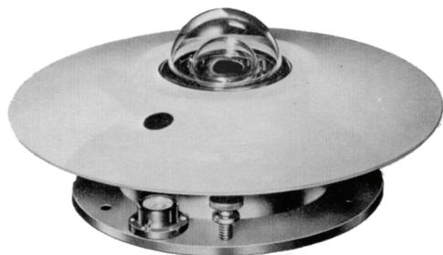
Figura 35 - Solarimetro: si osservino al centro le due cupolette in vetro e sotto a queste la superficie sensibile annerita.
