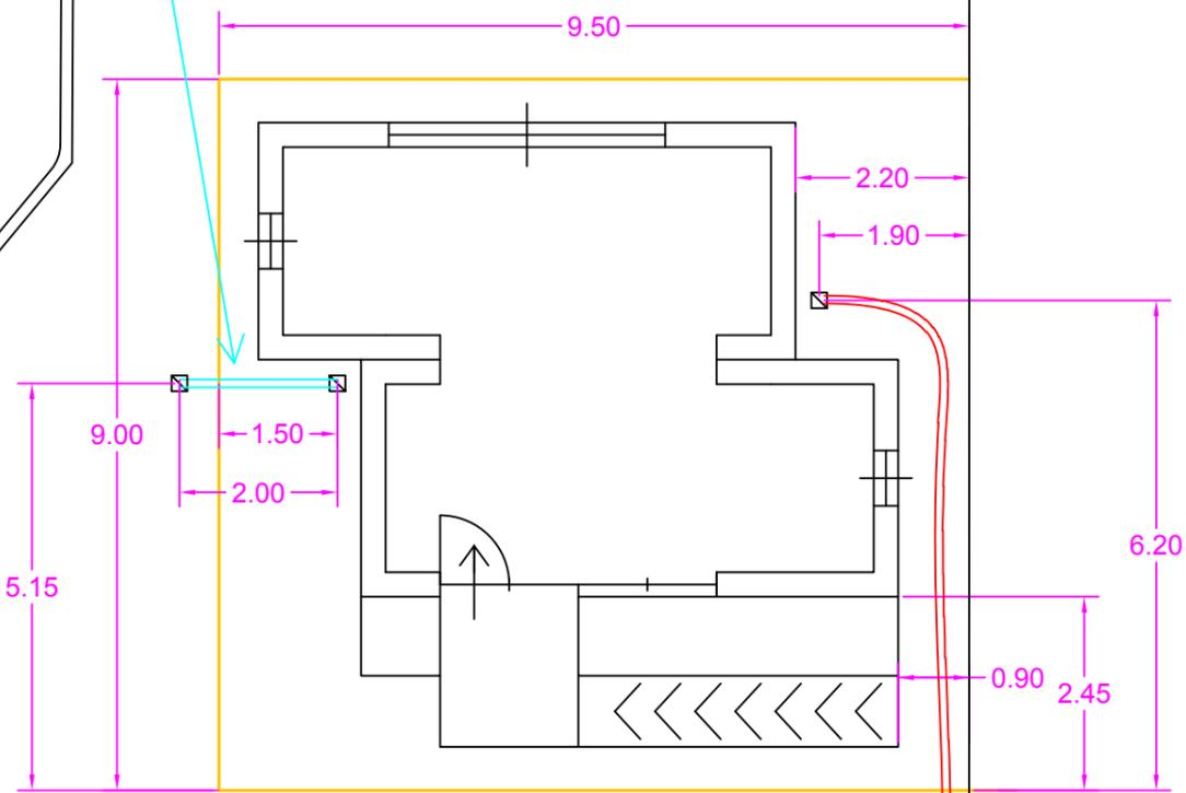
N. 2 cavidotti corrugati D. 40 mm per passaggio linea elettrica e linea dati
