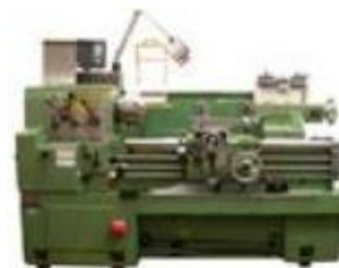
Alla destra di questo è fissato un rigido bancale in ferro o ghisa che è provvisto, nella sua parte superiore, di due guide parallele rettificata sulle quali scorrono un carrello su cui è montata la torretta portautensile e un sostegno da contropunta che ha la funzione di sorreggere eventualmente il pezzo in lavorazione (se trattasi di oggetto lungo) o di permettere l'esecuzione di fori assiali.
